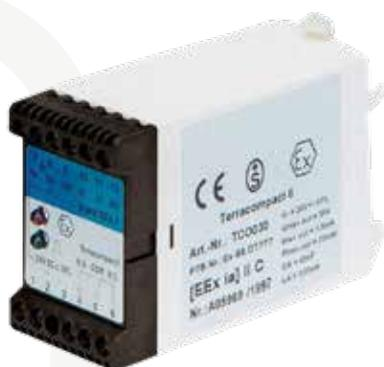
Durante los procesos de llenado o decantación de materiales sólidos o líquidos en zona ATEX, el Terracompact IITCO030 identifica automáticamente las conexiones a tierra erróneas o defectuosas en la instalación. Si el contacto libre de potencial se conmuta en consecuencia, interrumpe el proceso.
