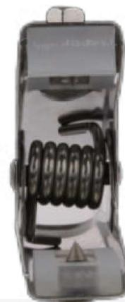
Estas pinzas de puesta a tierra están especialmente diseñadas para facilitar la descarga electrostática de partes del sistema potencialmente en peligro. Sus afilados dientes de acero inoxidable atraviesan las capas aislantes como la pintura, el óxido, la suciedad y la grasa gracias a la alta presión del muelle. De esta manera se puede crear una conexión efectiva “metal a metal” y garantizar una puesta a tierra segura.
