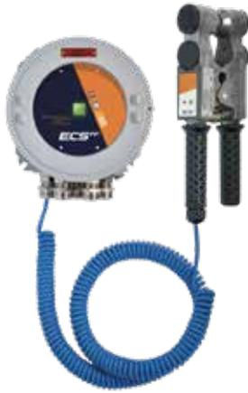
Los monitores de puesta a tierra de la serie ECS-RF permiten la conexión a tierra de los equipos de proceso (camiones cisterna, bidones, contenedores IBC, etc.) con una supervisión de la conexión en tiempo real. El sistema monitoriza que la conexión a tierra se obtiene con una resistencia inferior a  $10\Omega$ , de acuerdo con la Directiva ATEX 2014/34/UE.
