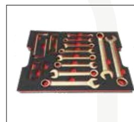
Las Herramientas Antichispa no pueden alcanzar la dureza de las herramientas convencionales. Por esta razón, en su empleo se debe tener un especial cuidado, sin sobreesfuerzos ni alta temperatura.
