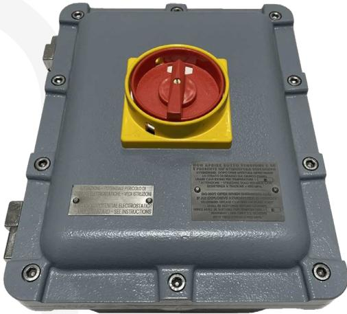
Interruptor de corte en carga de 80A de corriente nominal y 3 polos con certificado ATEX para operar en atmósferas explosivas. Apto para zonas clasificadas 1, 2, 21 y 22.
