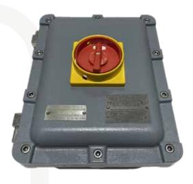
Interruptor de corte en carga de 40A de corriente nominal y 3 polos con certificado ATEX para operar en atmósferas explosivas. Apto para zonas clasificadas 1, 2, 21 y 22.
