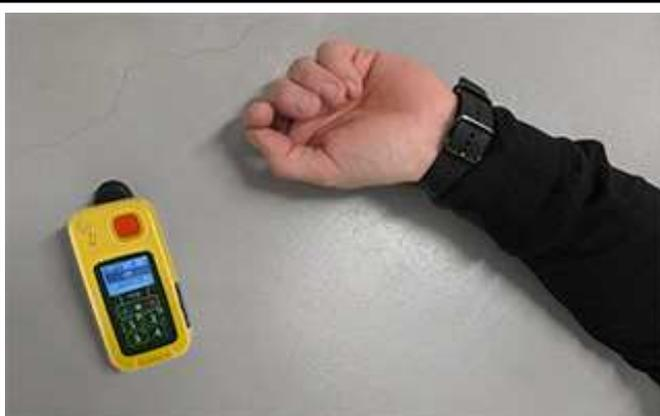
Se dispara la alerta automáticamente al detectar la orientación del dispositivo, la falta de movimiento, el impacto o la caída.
