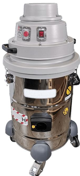
Aspirador industrial ATEX ST-22 EX ideal para evitar la formación de fuentes de ignición y que puede ser utilizado en Zona 22. Apto para polvos combustibles como carbón y aluminio.
