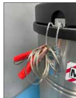
Aspirador industrial compacto certificado ATEX BL PRO Z22. Este aspirador está equipado con un potente motor Brushless que le permite trabajar rápidamente y aspirar el polvo más fino. Cuenta con un filtro principal en poliéster antiestático certificado Clase M. Además, se puede montar un filtro HEPA 14 opcional para aspirar incluso el polvo más fino. El material se recoge en un contenedor de acero inoxidable AISI 304 de 45 l de capacidad.
