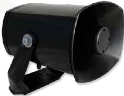
Este versátil altavoz de plástico de 25 W es ligero y cuenta con una espaciosa cámara de conexión de tipo de protección "e". Dispone de 2 entradas M20 en la tapa trasera para facilitar el cableado y admite la entrada y salida de bucle de serie.
